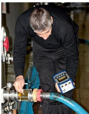
Mesure de l'oxygène au cours d'un transfert
