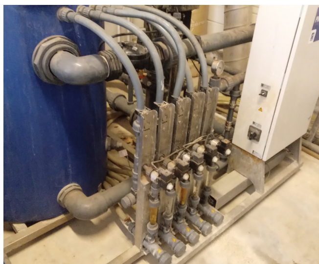
Systeme de contrôle des nutriments dans l'eau d'irrigation des cultures hors sol
